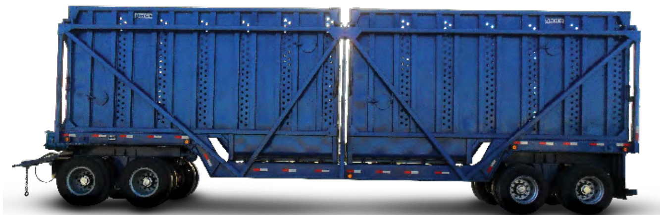
Reboque Canavieiro quatro eixos cana picada
